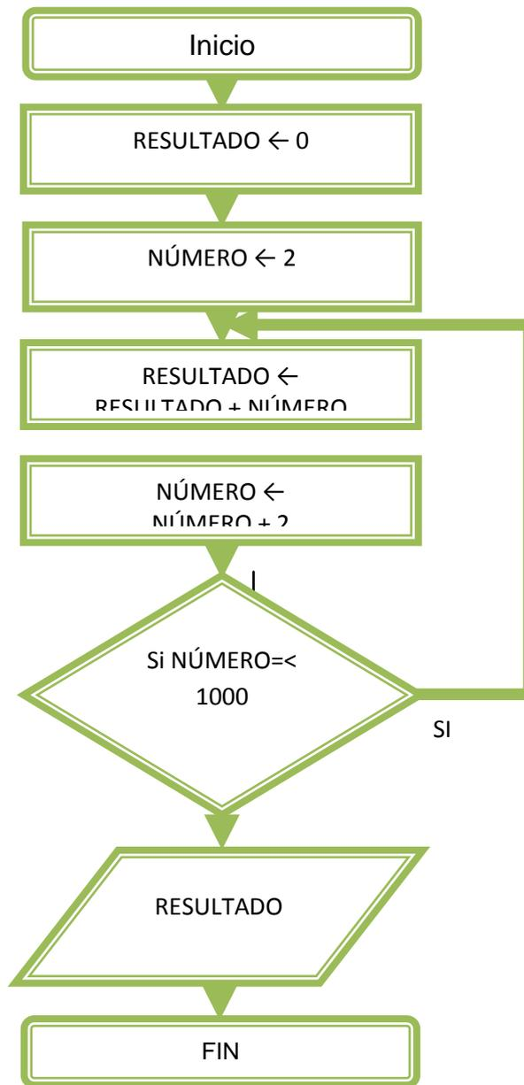
En este diagrama se emplea el símbolo de decisión para elegir dos caminos diferentes dependiendo del resultado de una comparación. Las salidas SI y No pueden intercambiarse de posición con la finalidad de ordenar la secuencia del diagrama.
