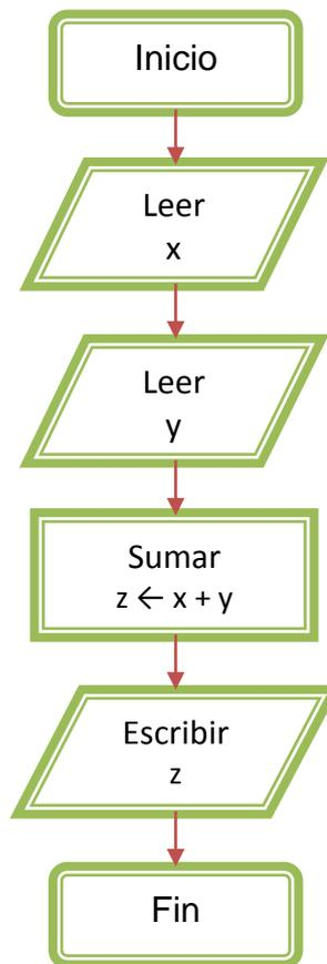
Si se observa con atención el diagrama de flujo, se puede apreciar que contiene 6 símbolos, mientras que el algoritmo propuesto sólo contaba con 5 pasos. La razón es que se agregó una salida de datos para mostrar el resultado de la suma. Sí se hubiera realizado el programa basándose únicamente en el algoritmo se tendría un error ya que aunque la suma se realizara, el resultado no se mostraría en la pantalla.
